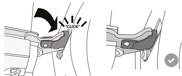
5. Zkuste dvířka zavírat a zkontrolujte, zda jsou v jedné rovině s ovládacím panelem. Pokud tomu tak není, výše uvedený postup opakujte. Pokud dvířka správně nefungují, mohou se poškodit.
