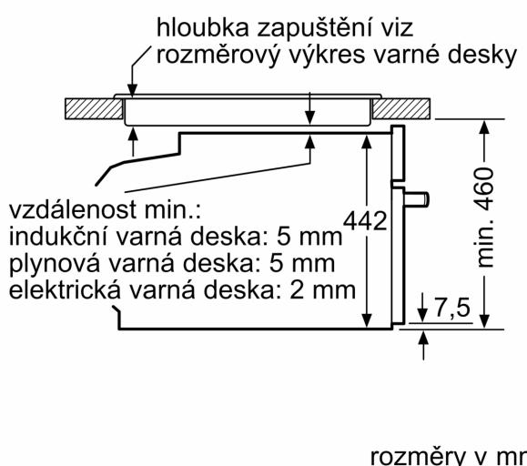
Pokud je kompaktní spotřebič vestavěný pod varnou deskou, musí být dodržená následující tloušťka pracovní desky (příp. včetně nosné konstrukce).
