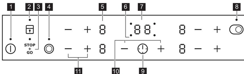
Spotřebič sa ovláda senzorovými tlačidlami. Zobrazenia, ukazovatele a zvuky vám oznámia, ktoré funkcie sú zapnuté.
