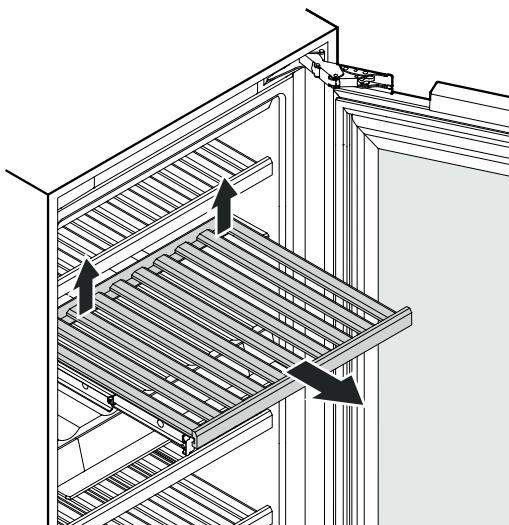
Dřevěný rošt vzdadu vpravo a vlevo nadzvednout (uvolnit) a vyndat ho směrem dopředu.
