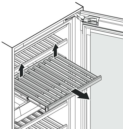
Dřevěný rošt v zadu vpravo a vlevo nadzvednout (uvolnit) a vyndat ho směrem dopředu.
