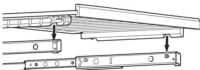
Vysouvací kolejnice zcela vytáhnout. Nasadit dřevěný rošt s předními prohloubeninami na přidržovací čepy.
