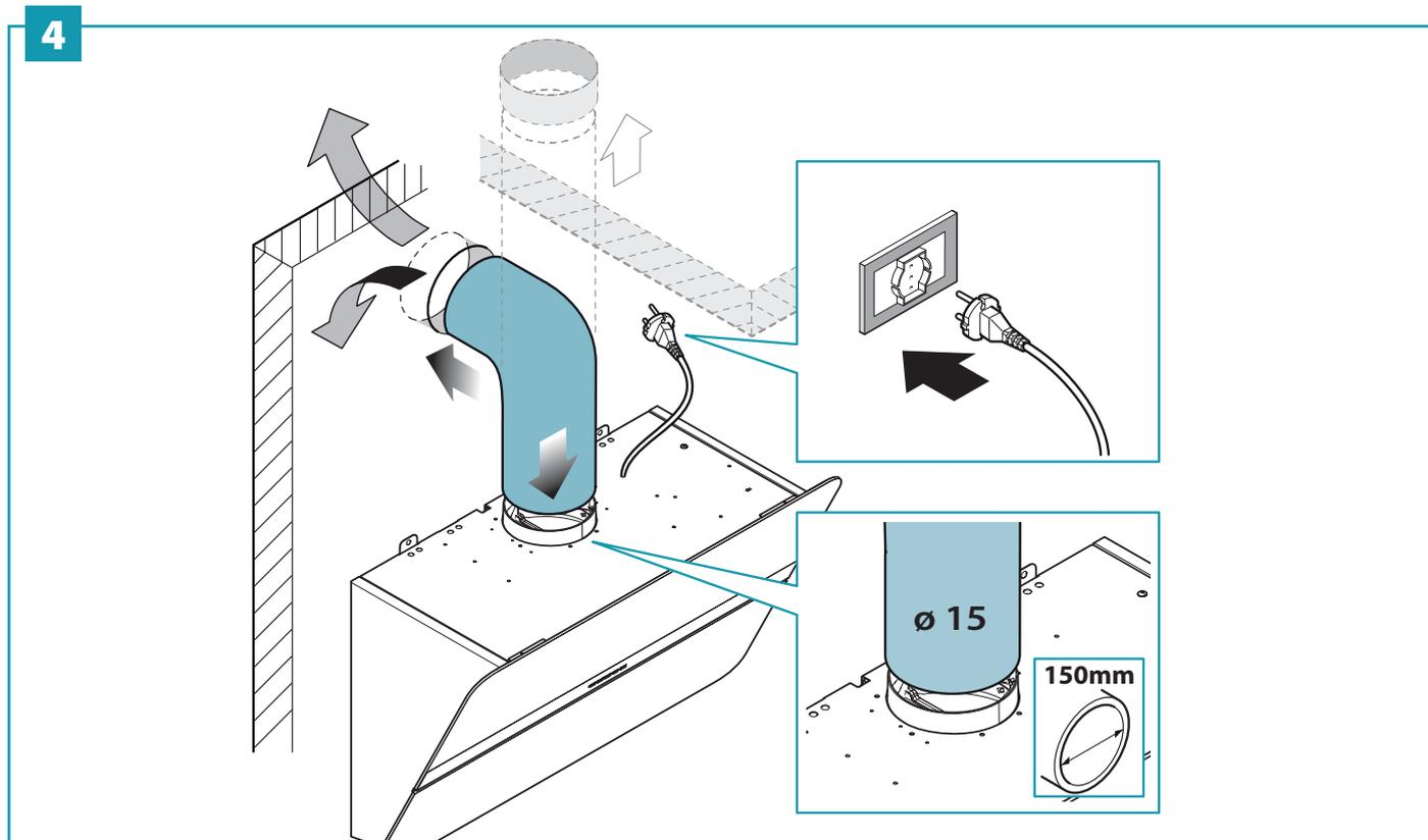
CZ - Instalace se zadním výstupem: Opatření pro instalaci (5).
