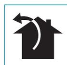
U ovoj verziji plinovi i pare su ispušteni vani kroz ispušnu cijev. Radi toga, izlaz nape mora biti spojen putem cijevi na vanjski izlaz.
