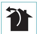
Nesta versão, fumos e vapores são direcionados para o exterior através do tubo de descarga. Para isso, a conexão de saída do exaustor deve estar ligada através de um tubo a uma saída externa.
