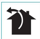
Dans cette version, les fumées et les vapeurs sont envoyées vers l'extérieur à travers un tuyau d'évacuation.
