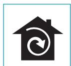
In questa versione l'aria passa attraverso i filtri al carbone attivo HP (opzionali) per essere purificata e riciclata nell'ambiente. Controllare che i filtri al carbone attivo HP siano montati sulla cappa, in caso negativo applicarli come indicato nelle istruzioni di montaggio.
