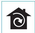
В этой версии воздух для его очистки поступает через фильтры с активированным углём (опциональные) и вновь подается в помещение. Убедитесь, что фильтры с активированным углем смонтированы на вытяжке, в противном случае установить их, как описано в инструкции по монтажу.
