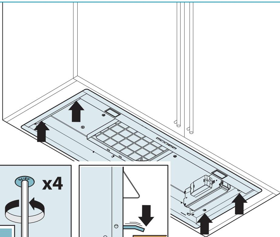
IT - Installazione valvola di non ritorno (6), camera motore (7) e collegamento elettrico (8).
