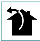
U této verze jsou výparы odváděny odtahovým potrubím mimo místnost instalace. Za tímto účelem musí být výstupní spojka digestoře připojena prostřednictvím odtahového potrubí k vnějšímu výstupu.
