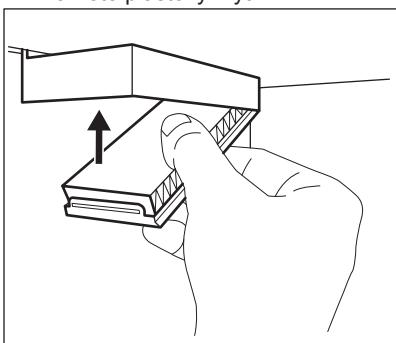
5. Po výměně filtru vypněte výstrahu stisknutím tlačítka Filter Reset výstrahy na ovládacím panelu. Nejlepšího výkonu dosáhnete, když plastový kryt umístíte na správné místo (vlevo od skleněné police) a vzduchový filtr každých 6 měsíců vyměňte. Pro další informace viz „Kontrolka výměny vzduchového filtru“.
