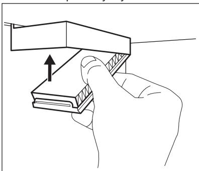
5. Po výmene filtra stlačte na ovládacom paneli tlačidlo alarmu Filter Reset, čím vypnete alarm. Na dosiahnutie čo najlepšieho výkonu umiestnite plastový kryt na správne miesto (naľavo od sklenenej poličky) a každých 6 mesiacov vzduchový filter vymenite. Ďalšie informácie nájdete v časti „Indikátor výmeny vzduchového filtra“.
