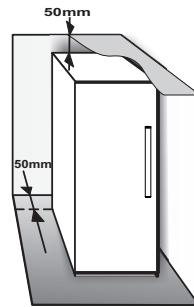
Құрылғының артқы жағы мен құрылғы артындағы қабырғаның арасындағы қашықтық 50 мм болуы тиіс.
