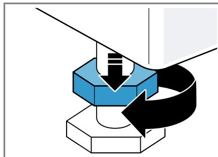
2. Pro vyrovnání spotřebiče otáčejte nožičkami spotřebiče. Vyrovnání zkontrolujte pomocí vodováhy.
