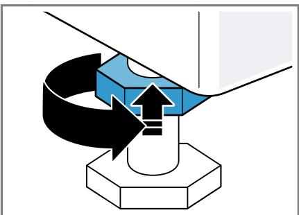
Nožičku přitom pevně držte a ne-měňte její výšku.
