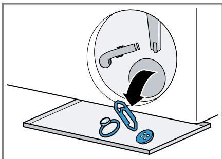
Víčko čerpadla se skládá ze dvou částí, které lze kvůli čištění rozmontovat.
