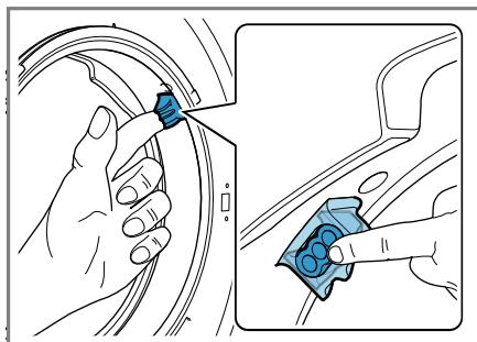
**18.4 Čištění otvoru v gumové manžetě**
