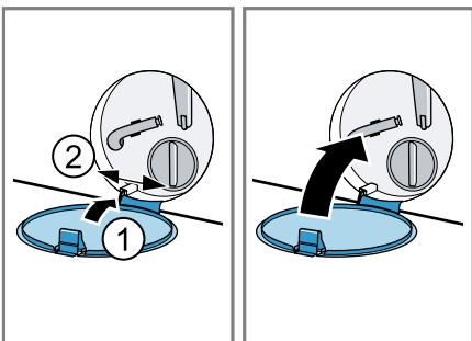
**2.** Odstraňte ucpaní z otvoru.
