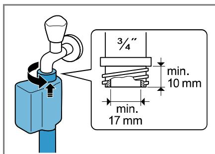
2. Opatrně otevřete přívod vody a zkontrolujte těsnost připojovacích míst.
