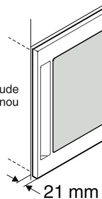
5. Nakonec upevnit spotřebič se šrouby do dřevotřísek 3,5 x 17 přes vrchní úhel.
